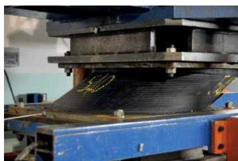
Yukarıdaki resim, test sırasında izolatörleri göstermektedir; sağ tarafta ise çeşitli yatay deformasyon değerlerine karşılık gelen histeretik döngüler çizelgesini gösterir. Çizelgeden de görüldüğü üzere deformasyon arttıkça düş etkin rıjilik değeri düşmektedir. Daha yüksek izolasyon tepkimesi elde edildiği için bu durumun rüzgar ve düşük şiddetli sismik olaylar açısından olumlu etkileri vardır.
